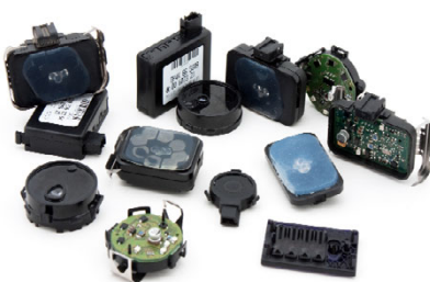
Sensores de lluvia y luminosidad con los que se ha trabajado
